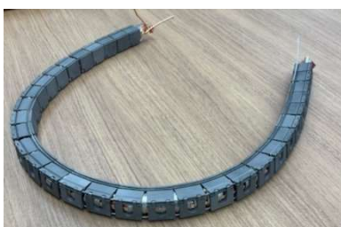
【Helical Fusion 社が独自開発する 高温超伝導導体】
